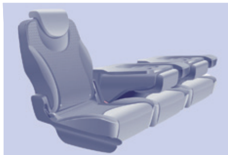
Typ 2 : dwa miejsca ze składanym oparciem i podnoszonym siedzeniem.
