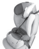
L5 "RÖMER KIDFIX" Peut être fixé sur les ancrages ISOFIX du véhicule. L'enfant est retenu par la ceinture de sécurité.
