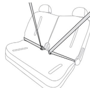
Les places arrière sont équipées de deux ceintures, dotées chacune de trois points d'ancrage et d'un enrouleur.
